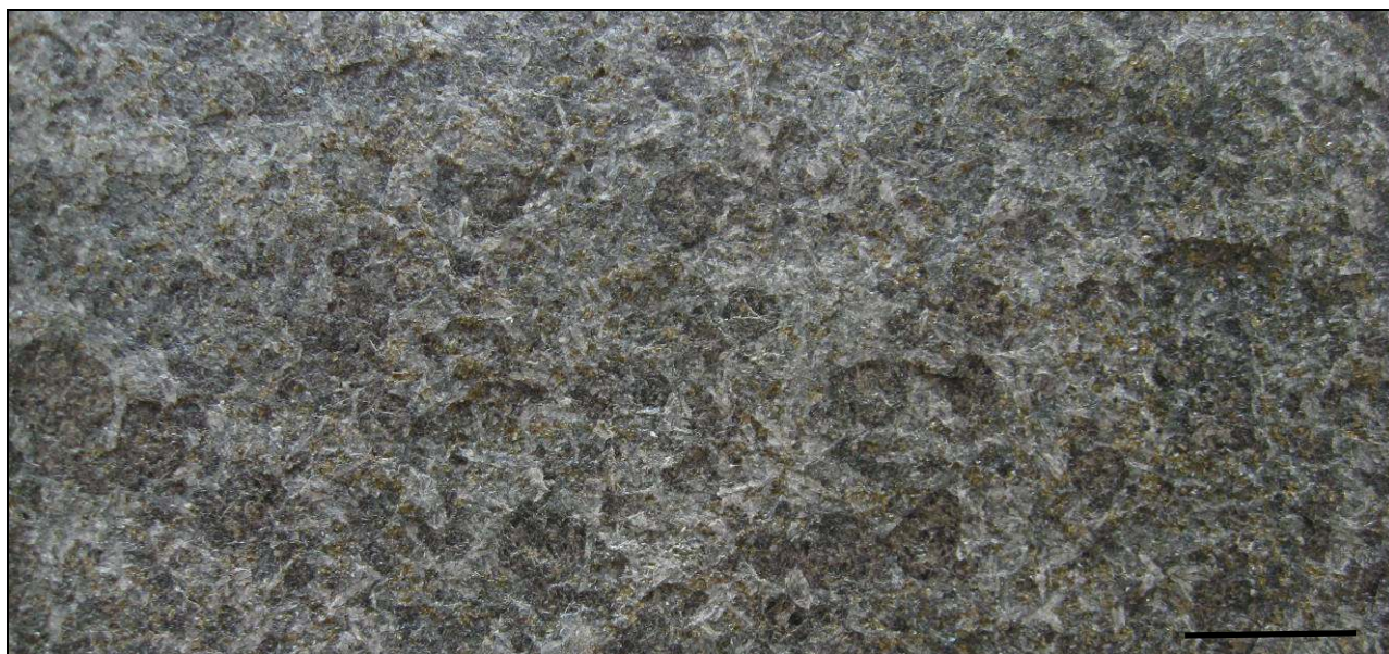
Fig. 6.2: Eksempel på en jetbrændt overflade af en gabbro. Skala = 10 mm.
