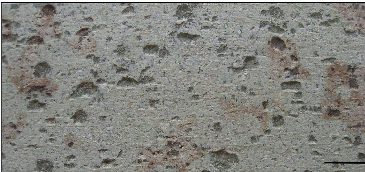
Fig. 6.3: Eksempel på strukturen af en høvlet kalkstensoverflade. Skala = 10 mm.
